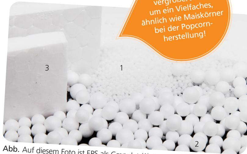
Abb. Auf diesem Foto ist EPS als Granulat (1), Vorgeschäumt (2) und als Endprodukt (3) zu sehen.
